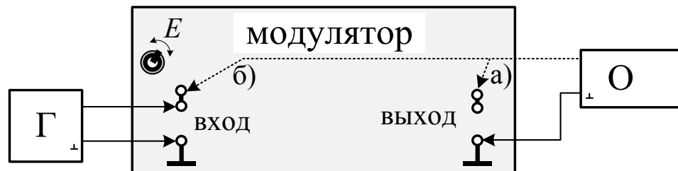
Рис. 2. Схема для наблюдения манипуляции частоты сигнала частотного модулятора. Подключение осциллографа к выходу модулятора – а), и ко входу модулятора – б). Ч – частотомер, О – осциллограф.
