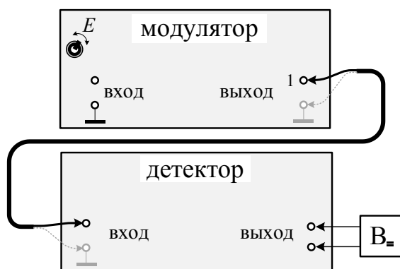
Рис. 5. Схема для измерения статической передаточной характеристики тракта с частотной модуляцией несущей частоты ( V_{\text{=}} – вольтметр постоянного напряжения).
