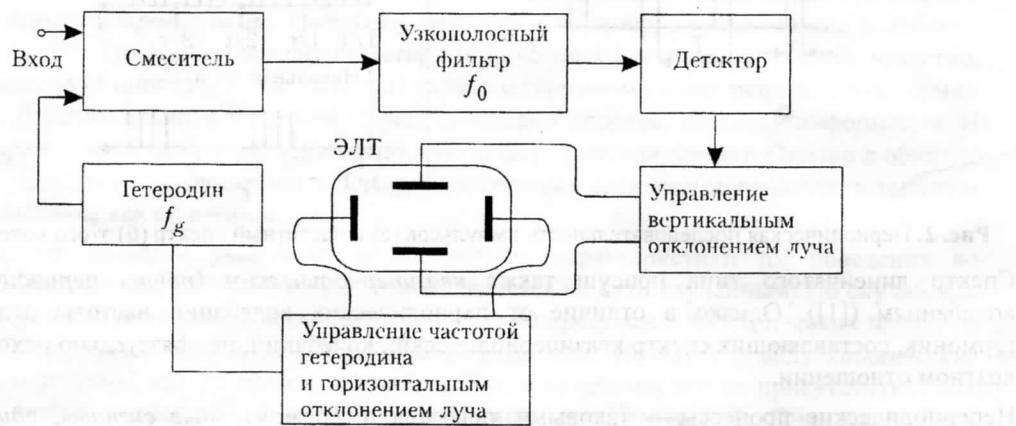
Рис. 4. Упрощенная схема наблюдения амплитудных спектрограмм
