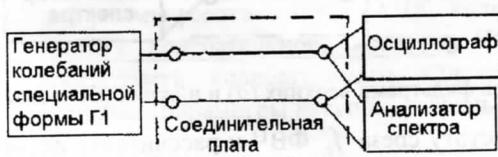
Рис. 19. Схема соединения приборов для исследования спектров периодических колебаний
