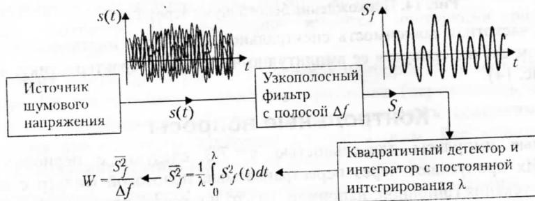
Рис. 13. Схема измерения спектральной плотности интенсивности шумового напряжения
