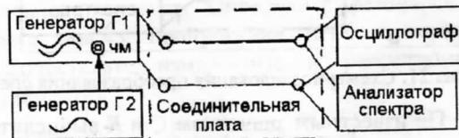
Рис. 20. Схема соединения приборов для исследования спектров ЧМ колебаний
