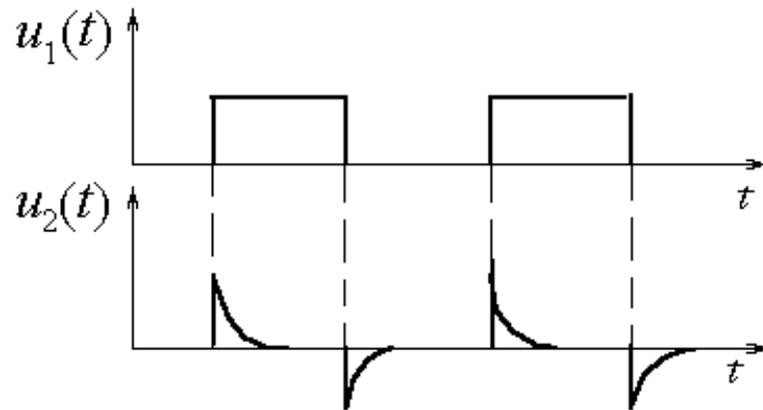
Цепь одинаково хорошо пропускает высокие частоты, но ослабляет низкие, а постоянную составляющую напряжения ( $\omega=0$ ) совсем не пропускает - простейший фильтр верхних частот (ФВЧ).
