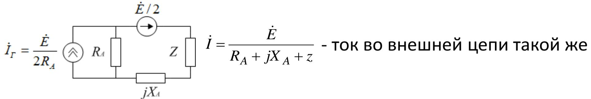
Если  $z = Z_A^*$  (антенна согласована с нагрузкой), токи через  $R_A$  от источника тока и ЭДС компенсируют друг друга. Мощность, расходуемая в  $R_A$ , равна нулю, соответственно,  $KПД=1$ .
