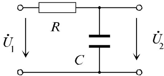
$$\dot{U}_2 = \frac{I}{j\omega C} = \dot{U}_1 \frac{\frac{1}{j\omega C}}{R + \frac{1}{j\omega C}}, \text{ откуда } K(j\omega) = \frac{\dot{U}_2}{\dot{U}_1} = \frac{1}{1 + j\omega RC}$$
