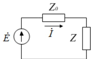
$z_0 = r_0 + jx_0$  - внутреннее сопротивление генератора
