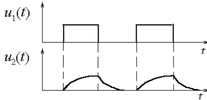
Граничная частота  $\frac{1}{\sqrt{1+(\omega_{GP}RC)^2}} = \frac{1}{\sqrt{2}} \rightarrow \omega_{GP} = \frac{1}{RC}$
