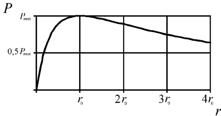
$$P_{0 \max} = \frac{E_{\partial}^2}{4r_0} \quad \text{мощность в сопротивлении генератора}$$
