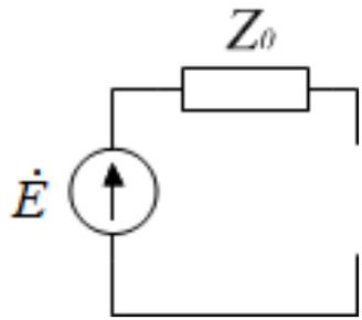
Схема эквивалентна источнику лишь в том смысле, что она позволяет правильно рассчитывать процессы во внешней цепи. Однако она не обязательно правильно отображает процессы в самом генераторе.
