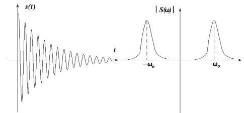
Спектр сосредоточен вблизи частоты  $\omega_0$ . Если  $\alpha << \omega_0$  —> относительная ширина спектра мала:  $\Delta \omega / \omega << 1$  —> имеем квазигармоническое колебание.
