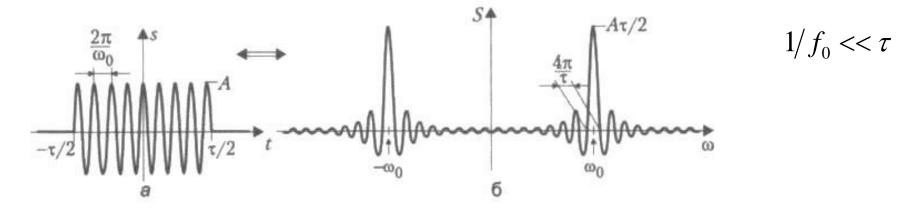
$s_1(t) = s(t) \cdot \cos(\omega_0 t)$ , где s(t) — импульс из предыдущего примера (прямоугольный импульс).
