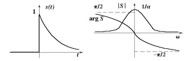
Форма зависимости  $S(\omega)$  как у АЧХ резонансного контура (лоренцева кривая), причем  $S \approx 1/\omega$  при  $\omega \to \infty$ .
