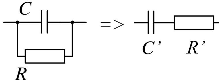
$$d = \frac{r_{\text{собств}} + r_{\text{внеш}}}{\rho} \quad \text{- общее затухание} \rightarrow Q = \frac{1}{d} \quad \text{нагруженная добротность}$$
