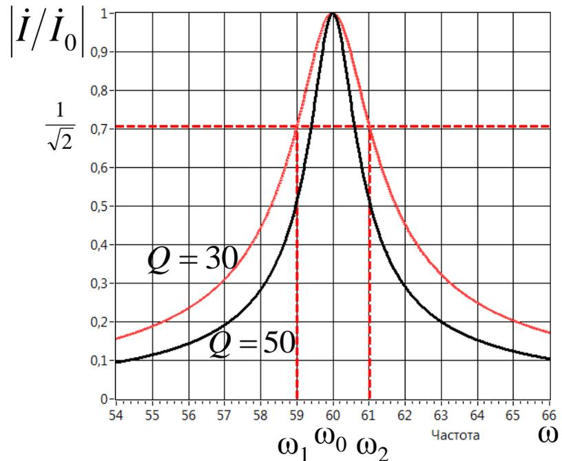
График зависимости  $|i/i_0|$  от  $\xi$  симметричен,
