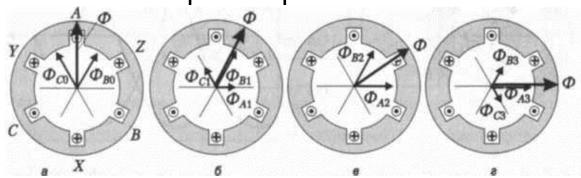
Для изменения направления вращения достаточно поменять местами токи в каких-либо двух обмотках (например  $i_{B}$  ,  $i_{C}$ ), а в двухфазном — изменить полярность одной из обмоток. При несимметрии токов вместо кругового вращения получается вращение по эллипсу.
