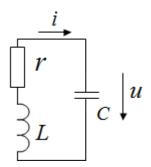
Свободные колебания не являются гармоническими, и к ним непосредственно метод КА не может быть применен.  $L\frac{di}{dt} + ri + u = 0, \quad i = C\frac{du}{dt} \quad -> \quad LC\frac{d^2u}{dt^2} + rC\frac{du}{dt} + u = 0$
