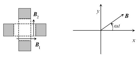
Вектор индукции магнитного xy с частотой  $\omega$  , его длина
