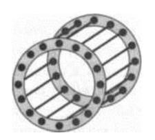
Внутри статора электродвигателя размещают Вращающееся магнитное ротор. поле возбуждает в роторе токи и индуцирует вращающий момент, который приводит ротор в движение.
