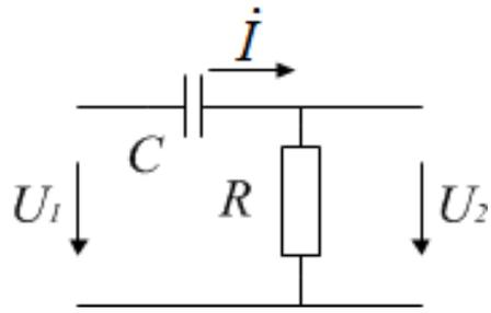
$$\dot{U}_1 = \dot{i} \left( R + \frac{1}{j\omega C} \right), \quad \dot{U}_2 = \dot{i}R = \dot{U}_1 \frac{R}{R + \frac{1}{j\omega C}} = \dot{U}_1 \frac{j\omega RC}{1 + j\omega CR}$$
