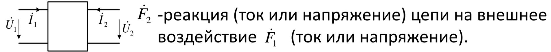
$\dot{K}(j\omega) = \frac{\dot{F}_2}{\dot{F}_1}$  - комплексный коэффициент передачи, (передаточная функция или передаточная характеристика).
