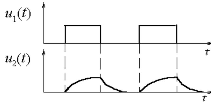
Граничная частота  $\frac{1}{\sqrt{1+(\omega_{ГР}RC)^2}} = \frac{1}{\sqrt{2}} \rightarrow \omega_{ГР} = \frac{1}{RC}$
