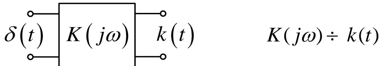
Импульсная характеристика связана с частотной передаточной функцией преобразованием Фурье.
