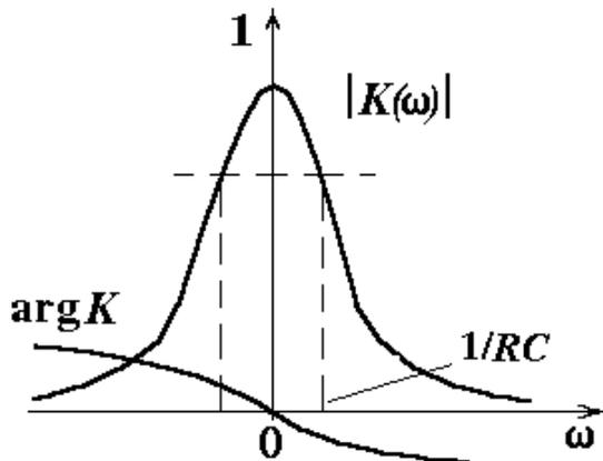
В полосе  $0 < \omega < 1/RC$  АЧХ изменяется от 1 до  $1/\sqrt{2}$  (немного), а ФЧХ близка к линейной зависимости.
