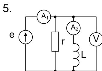
На входе электрической цепи действует ЭДС с частотой 1 КГц. Показания приборов, включенных в цепь, на частоте  $f = 1$  КГц:  $I_1 = 5$  А,  $I_2 = 3$  А,  $U = 220$  В. Найти  $r$  и  $L$ , а также найти значения  $I_1$  и  $I_2$ , если частота  $f$  генератора уменьшится в два раза.
