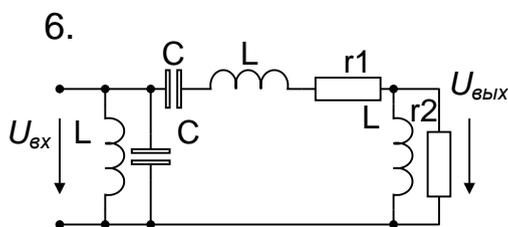
В цепи действует синусоидальный сигнал на частоте 12.5 КГц.
