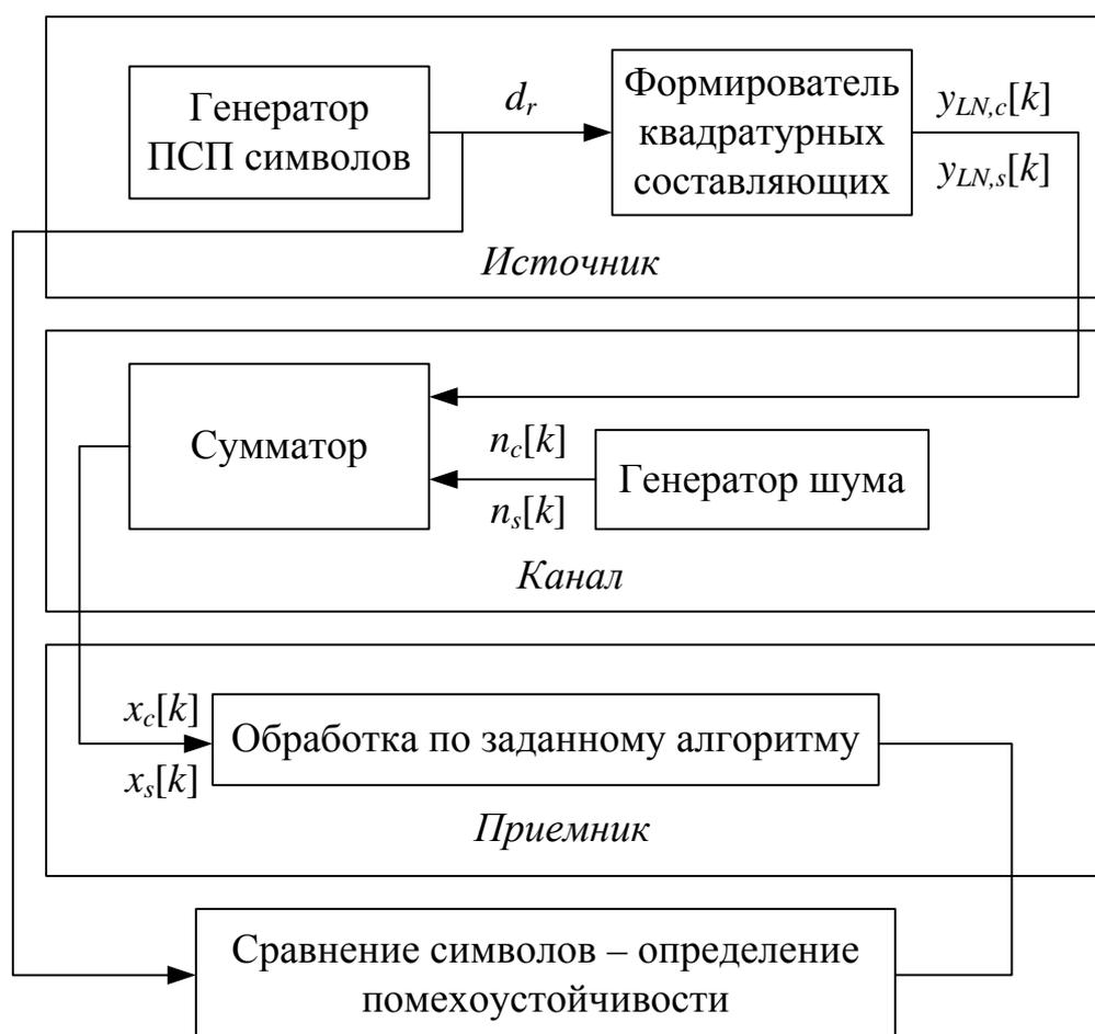
Рис. 4.10. Структурная схема программы имитационной модели
