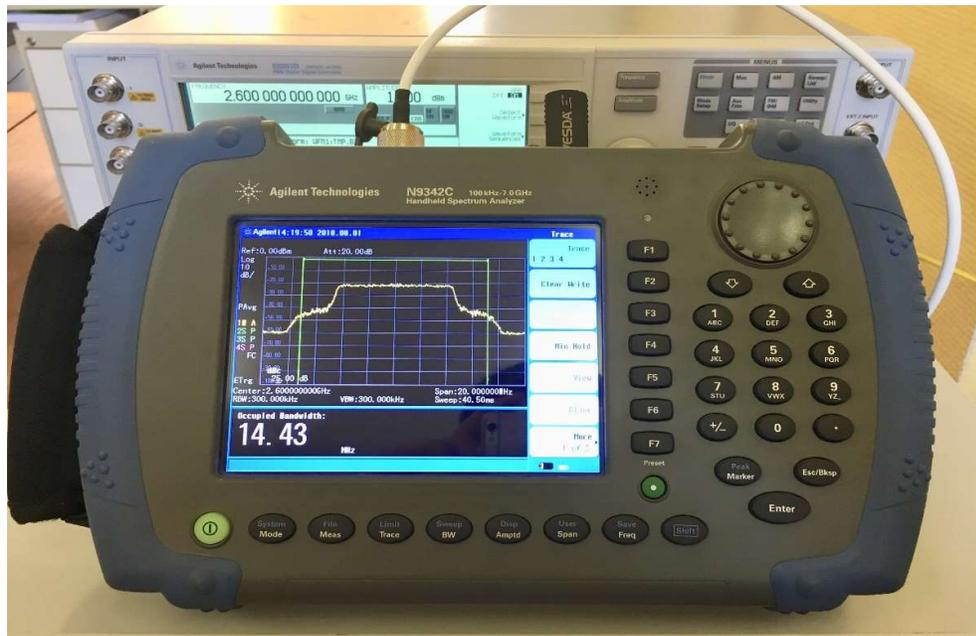
Рис. 4.14. Спектроанализатор Agilent N9342C
