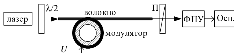
Рис. 3.1. Экспериментальная установка по определению эффективности поляризационных модуляторов. \lambda/2 – полуволновая пластинка, П – анализатор (линейный поляризатор), ФПУ – фотоприёмное устройство, Осц. – осциллограф.
