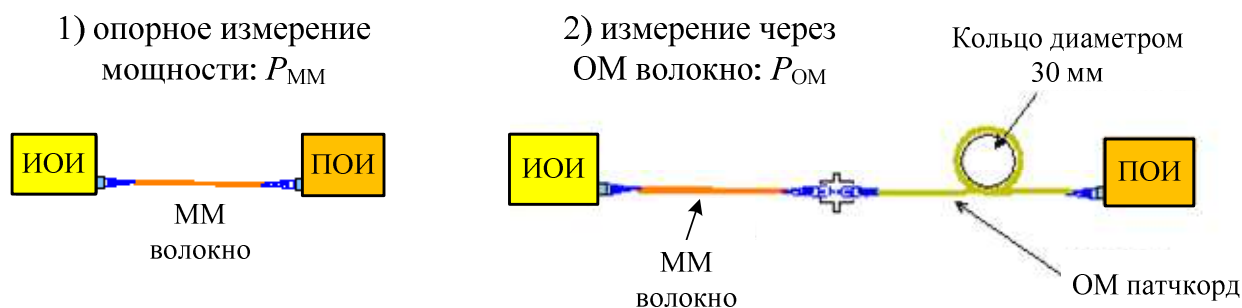
Рис. 1.3. Схема измерения параметра CPR.
