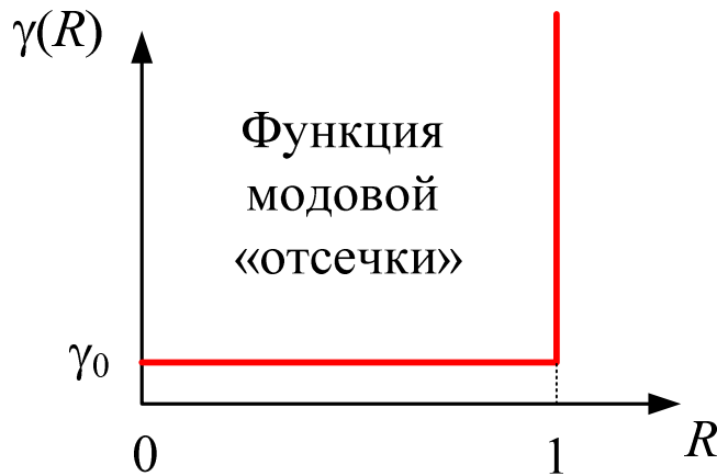
Рис.2.5. Упрощенный вид функции дифференциальных модовых потерь, где коэффициент затухания для всех мод одинаков.
